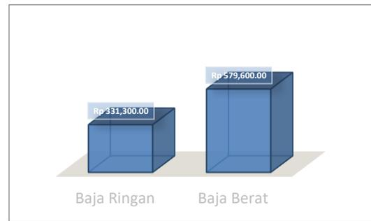
**Bagan 10. Perbandingan Harga per meter persegi Kerangka Atap Baja Ringan dan Kerangka Atap Baja Berat**
