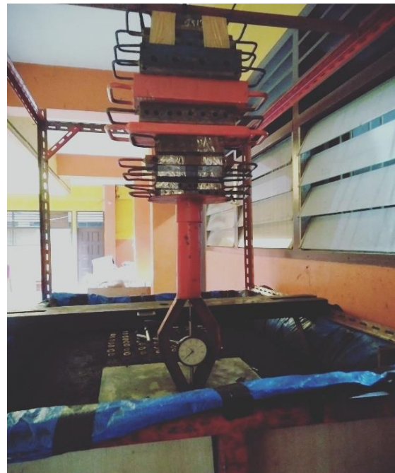
Gambar 3. Uji Beban Pelat
