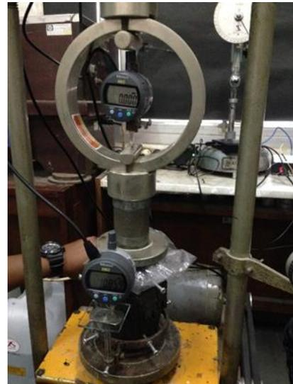
Gambar 4. Pengujian Kuat Tekan dan Modulus Elastisitas BU UCS Menggunakan Alat Marshall yang Dimodifikasi
