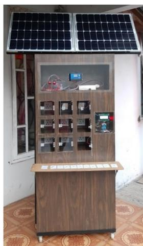
**Gambar 10. Gambar keseluruhan alat tempat pengecasan gawai untuk umum**
