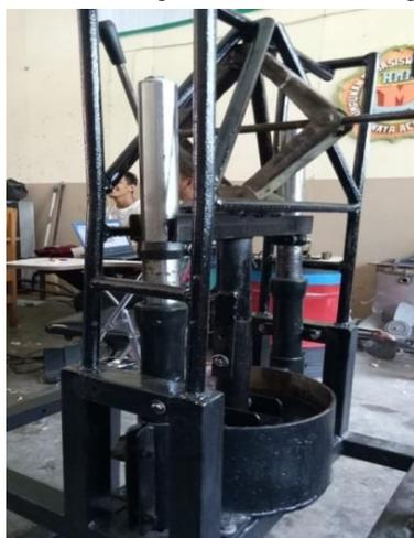
**Gambar 4.** Hasil Rancangan alat *Press Hydraulic* dengan tekanan 318,3 Kg/m<sup>2</sup>
