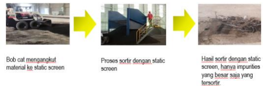
Gambar 2. Proses Sortir Manual Impurities Material pada LB3
