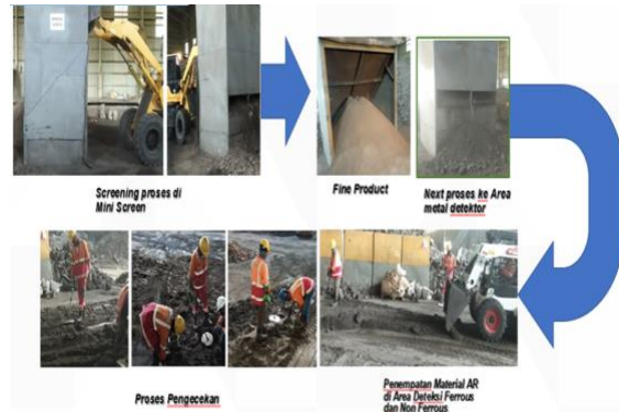
Gambar 6. Proses Screening Menggunakan Alat Mini Screen
